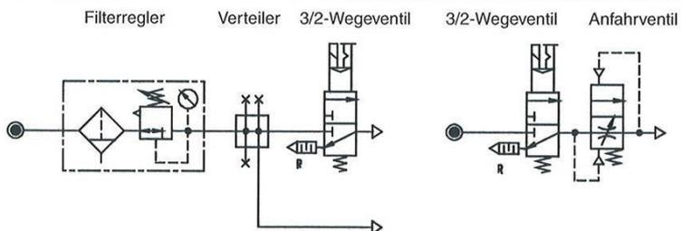
Druckluftanlagen oder Teile von Anlagen können ein- oder abgeschaltet und entlüftet werden.
